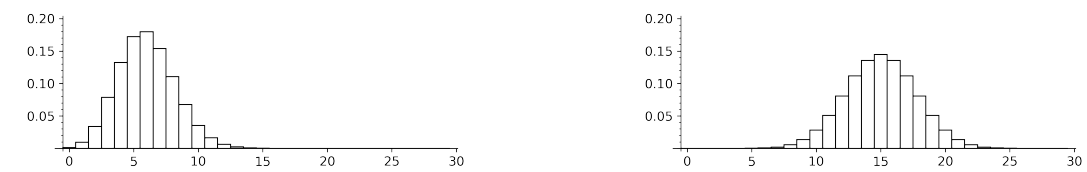
圖 2.2: 二項式分佈的質量函數，左圖的參數為 n = 30, p = 0.2 ，右圖的參數為 n = 30, p = 0.5 。
